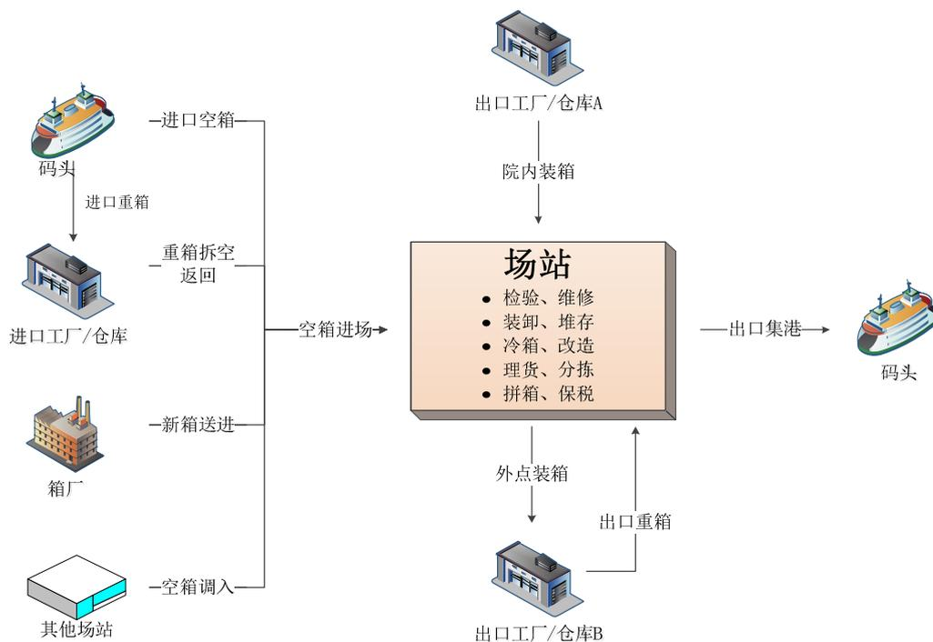
集装箱的空箱进场是公司场站业务的开端，空箱进场包括以下多种方式：进口空箱是指由船舶经营人托运空箱至码头，公司用拖车将空箱托运至场站；重箱拆空返回是指进口货物提至工厂或仓库将货物拆空后，空箱送到场站；新箱送进是指公司从箱厂或起租地将空箱拖运至场站；空箱调入是指公司从其它场站将所需的空箱调至场站。公司通过自己配备的集装箱拖车和协议的外包运输车队，保证了空箱拖运进场的及时性。
