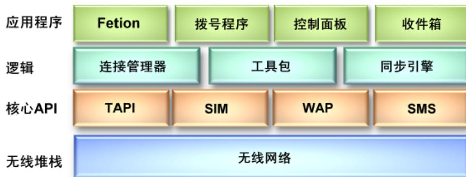
无线堆栈层，负责语音和数据控制以及数据传输的体系结构组件；核心 API 层，提供的是底层体系结构组件与应用程序层/逻辑层之间的接口；逻辑层，包含可以被应用程序层使用的系统应用程序逻辑；应用程序层负责操作系统内置或第三方开发的应用程序。
